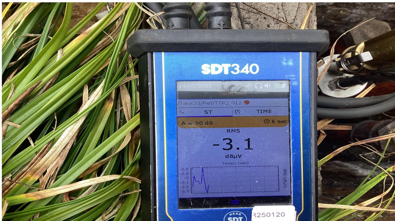
Listing test d'étanchéité du réservoir
